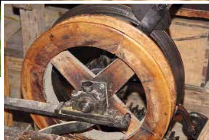
Bewährte Technik: Die Wasserkraft treibt Räder an, die dafür sorgen, dass sich scharfe Sägezähne stetig ins Holz fressen
